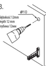
Wykonaj otwór Ø 10mm i głębokość 12mm.
