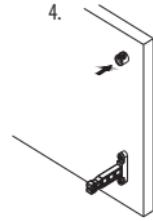
W miejsce otworu wciśnij mocowanie relingu w panel frontowy.
