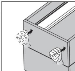
Po ustawieniu pozycji frontu należy lekko uderzyć panel frontowy. Zostaną zaznaczone otwory montażowe.
